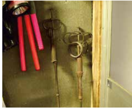
これが「じゃらん棒」。何度も折れてその度に溶接して使っている。重さは1.5キロぐらい。
